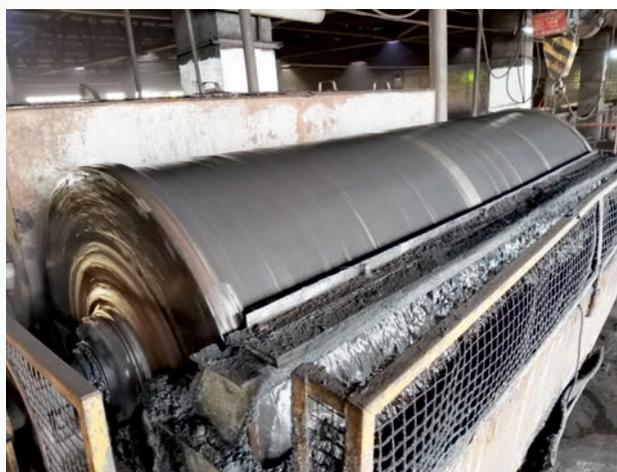
Наша компания имеет значительный опыт в восстановлении и ремонте вышедших из строя барабанов. Так, например, мы можем осуществить диагностику и восстановление магнитной системы, изготовить обечайку из нержавеющей стали высокого качества, заменить или восстановить зубчатые колеса, заменить подшипниковые узлы, произвести внутреннюю очистку от магнетита и прочее.
