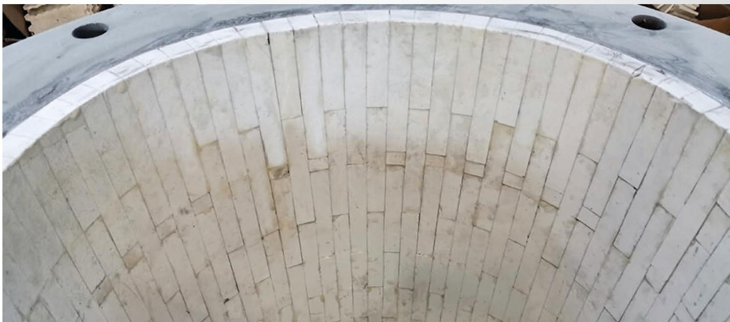
Для осуществления частичного и капитального ремонта футеровки рабочей поверхности оборудования на производственной площадке Русмайн Инжиниринг осуществляется комплекс технологических операций по удалению старого покрытия, пескоструйной обработки металлической поверхности, шлифовки и дальнейшему нанесению футеровочных материалов.
