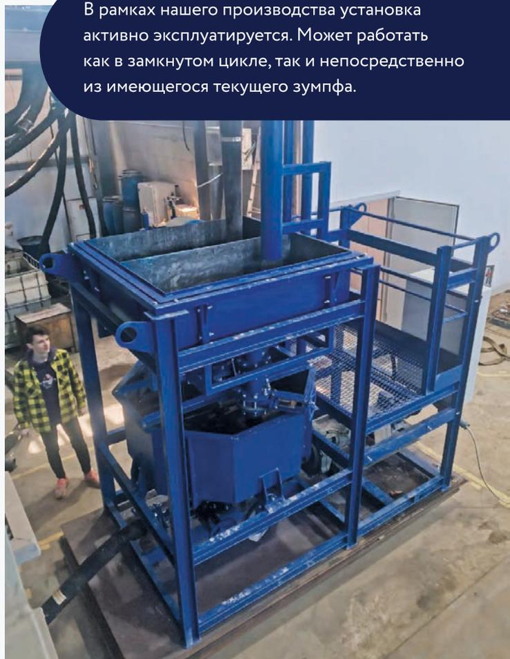
В рамках нашего производства установка активно эксплуатируется. Может работать как в замкнутом цикле, так и непосредственно из имеющегося текущего зумпфа.
